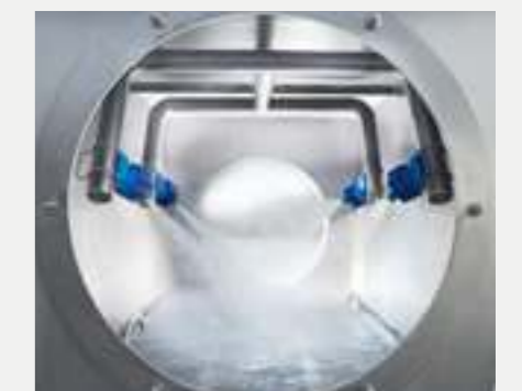
Funcionamiento de la unidad de limpieza del filtro
